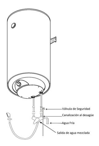
Las entradas y salidas de agua se deberán conectar según lo indicado en este manual, ayudándose por los colores. El color azul indica entrada de agua fría, y el rojo, salida de agua caliente.
